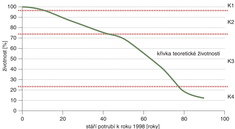
Obr. 3: Křivka životnosti potrubí z šedé litiny
